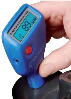
**注意：**测量时务必要使探头垂直接触被测物表面、并压实，每测量一次后将仪器拿起，离开被测物10cm以上，再进行下一点测量。
